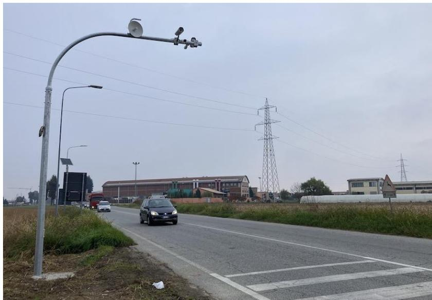
I punti individuati per il posizionamento dovranno essere serviti dalla rete di energia elettrica e dotati di sufficiente spazio sulla banchina stradale per consentire la formazione del plinto di sostegno al di fuori della fascia di rispetto stradale.
